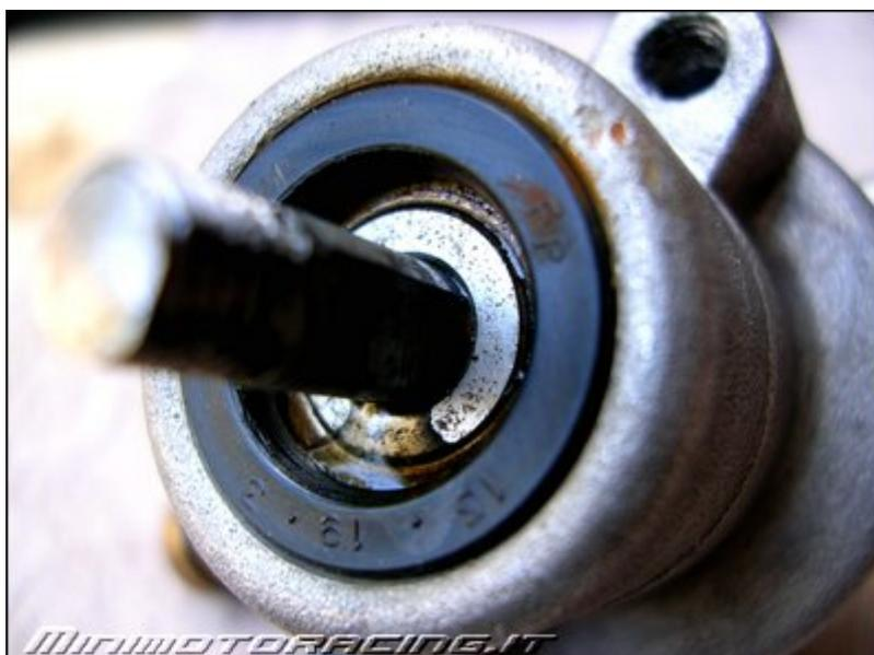
Per il paraolio esterno si fa leva con un cacciavite e salta via facilmente, a questo punto poggiate il tutto sul tavolo e fate scorrere i cuscinetti utilizzando un cilindro di nylon o di alluminio in modo che i cuscinetti possano uscire dal lato della puleggia, controllate che non siano completamente bloccati dalla ruggine, quando la moto sta ferma per anni andrebbero cambiati.
