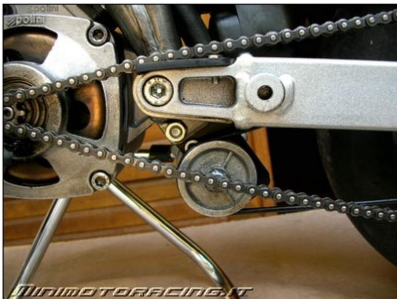
Aperte le fascette stringi tubo che bloccano il tubo di ingresso (assiale) e quello di uscita (radiale) e scollegate i tubi facendo scolare l'acqua in un recipiente. una volta che l'acqua sarà fuoriuscita tutta potete svitare la puleggia tenendola ferma con una mano e svitando il dado con una chiave mis.10 (nel caso potete tenere ferma la puleggia con un giratubi ma occhio a non rovinarla)
