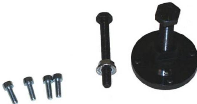
Rimuovere il pignone e l'anello elastico quindi fissare l'estrattore al carter tramite almeno due viti abbastanza lunghe da garantire una buona presa nello stesso.
